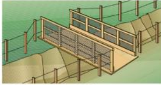
Figura 5 - Passarela em escavação para circulação de pessoas
